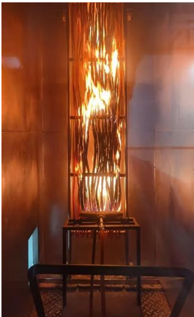
Figura 3. Prueba resistencia a la llama
